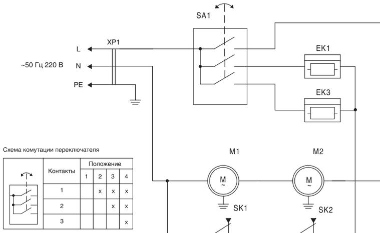
EK1, EK2 – электронагреватели; SK1, SK2 – защитные термостаты без автовозврата; M1, M2 – электродвигатели; XT1 – вилка сетевая; SA1 – переключатель режимов работы;
