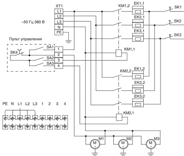
EK1, EK2, EK3 – электронагревательные элементы; SA2, SA3 – выключатели нагревателей; M1, M2, M3 – электродвигатели вентиляторов; SK1, SK2, SK3 – защитные термостаты; SK4 – терморегулятор; KM1, KM2 – магнитные пускатели; SA1 – сетевой выключатель; XT1 – колодка клемная.
